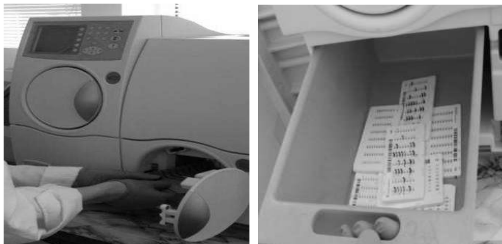
Fig. 7. Incubarea cardurilor pentru testarea sensibilității la substanțele antimicrobiene prin metoda microdiluțiilor
