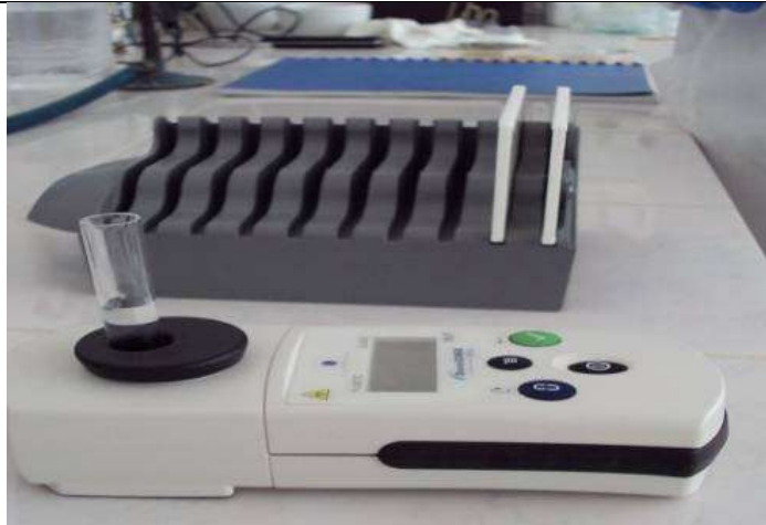
Fig. 5. Măsurarea turbidității suspensiei bacteriene cu ajutorul aparatului DensiCheck
